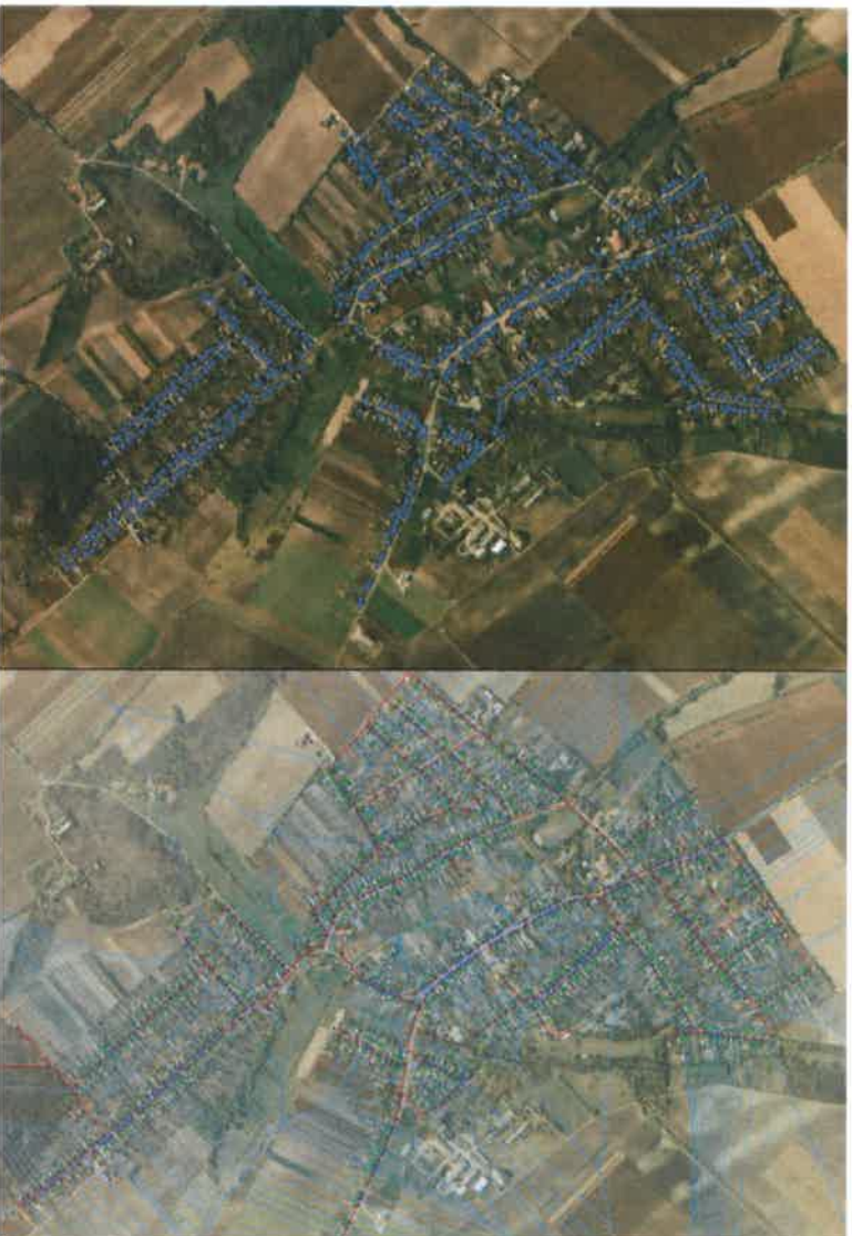
23. ábra - Fogyasztók térbeli ábrázolása (DR1-számlázási adatok alapján) és hálószerkezetek meghatározása
